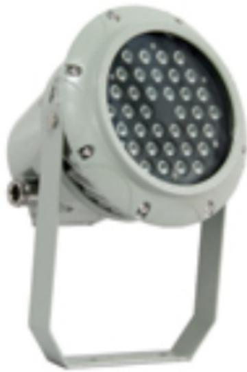
防爆灯的防爆结构型式，要根据性气体环境的区域等级及范围决定，如1区范围内必须采用隔爆型灯具；2区内的固定灯具可采用隔爆和增安型，移动式灯具必须采用隔爆型。所选防爆灯的级别或组别，不应低于危险环境中混合物级别和组别。同时要考虑环境对防爆灯的影响，应满足环境温度、空气湿度、腐蚀或污染性物质等各种不同环境的要求。要根据不同的环境要求选择灯具的防护等级和防腐等级。尤其是在性气体环境中存在腐蚀性气体时，选择具有相应防腐性能的灯具是至关重要的。
